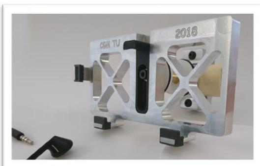
Il a été demandé aux candidats de réaliser un support de smartphone. Sa fonction principale est de positionner un smartphone sur un guidon de vélo. Plusieurs matériaux ont été mis en œuvre : aluminium, laiton, POM, ABS.
